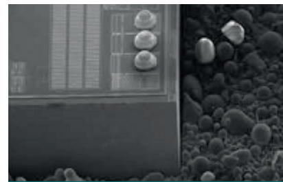
Интегральная микросхема с наклоном 45° (x300)
