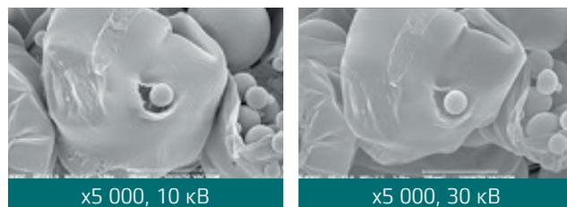
→ Повреждение частиц порошка при изменении напряжения
