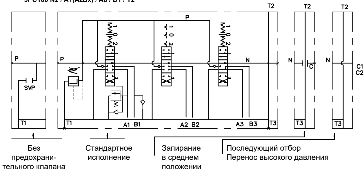
Параллельный контур ЗРС100 N2 / A1(AzBx) / A8 / D1 / T2
