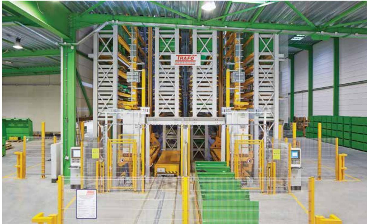
Предназначены для хранения и размещения металлопроката, а также тяжелых грузов различного веса, типа и габаритов. Представляют собой зону хранения из стеллажей с местами размещения ТМЦ и штабелер-автоматом, который перемещается между стеллажами. Штабелер выполнен в виде рамы, стоящей на рельсах. Между опорами находится подъемная платформа. На штабелере установлен экстрактор – механизм перемещения несущего элемента.
